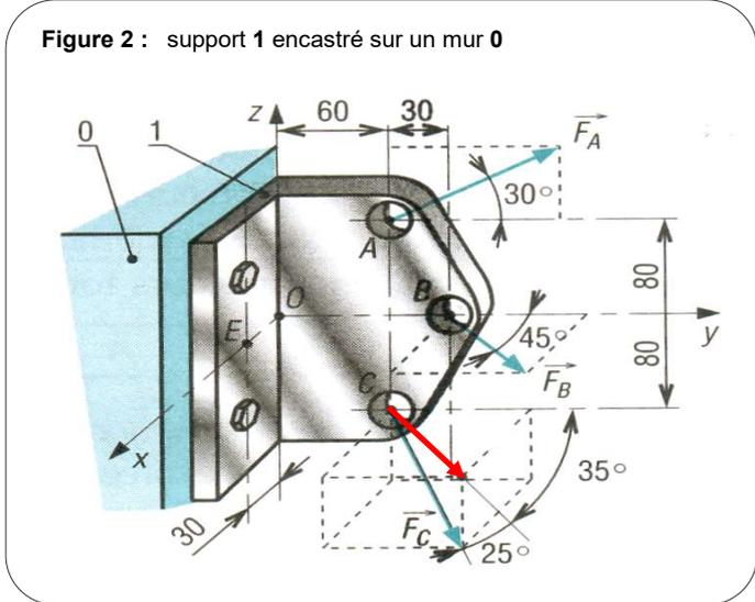
Figure 2 : support 1 encastré sur un mur 0
